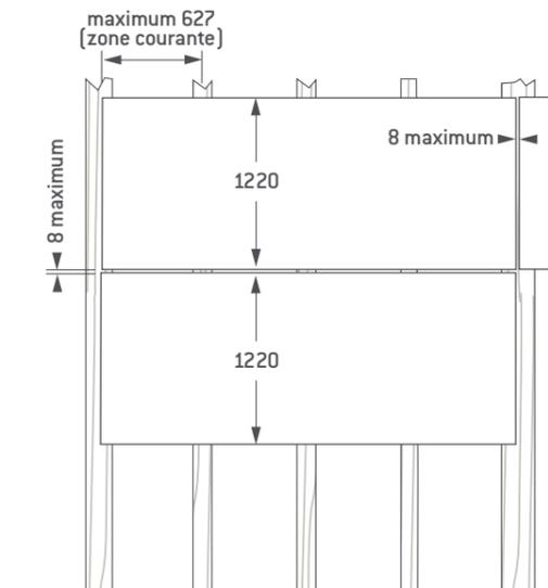
\* Ces préconisations s'appliquent sur voile béton. Pour tout autre type de support, une note de calcul par le fabricant de fixations est nécessaire.
