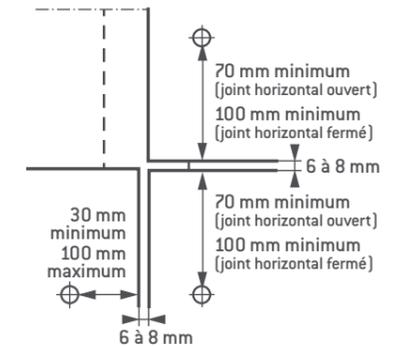
La répartition des fixations doit être conforme aux tableaux des pages 38 et 65.
